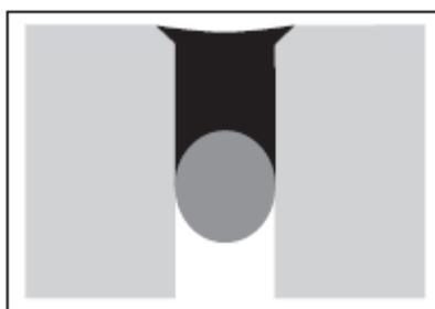
Конструкция шва заподлицо без выступов, исключает возможность спотыкания и скопления грязи.
